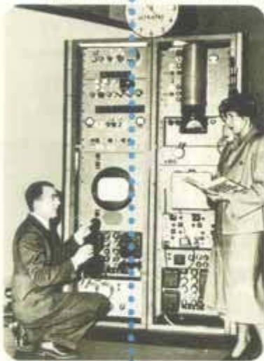
1948 Ultrafax: „Vom Winde verweht“ - 1000 Textseiten in 2,5 Minuten
